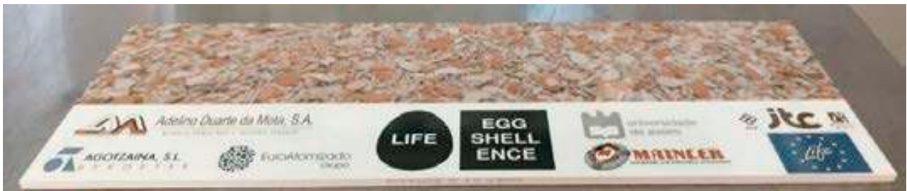
Figura 11. Baldosa de azulejo obtenida industrialmente con la composición con un 5% de bio-carbonato
